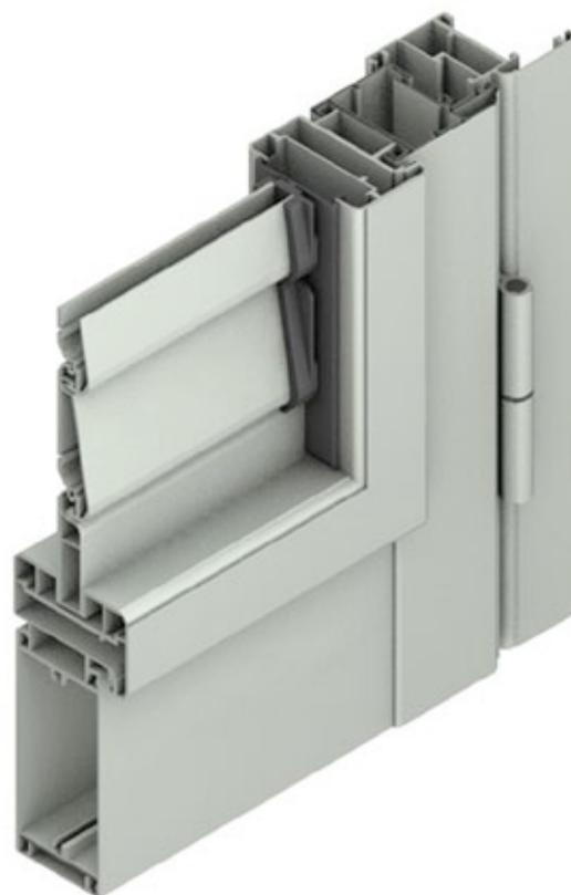
Sistema per la realizzazione di persiane a battente con sportello regolabile, utile per non aprire l'anta. Ideato per adattarsi a costruzioni in stile rurale, ma anche a strutture tipiche della Toscana o centri storici. La sua robustezza, garantisce una migliore protezione agli infissi. Cerniere e altri dettagli, in stile.
