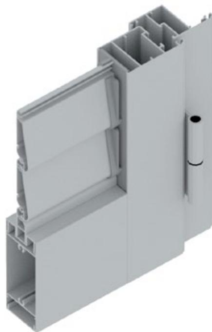
Sistema per realizzare persiane a battente con sportello regolabile, utile per non aprire l'anta. Ideato per adattarsi a strutture di ogni tipo ma, indicata per centri rurali, storici o ristrutturazioni. La sua robustezza, garantisce un'alta protezione degli infissi. Possibilità di cerniera a scomparsa, nella versione con cardini
